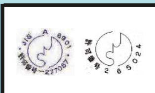
ヒ素・カドミウム入り 石膏ボード
